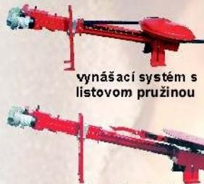
Systém určený na vynášanie pilín, štiepky, stružín, peliet a pod. z bočného sila alebo skladu. Dve sústavy listových pružín umožňujú pohyb v malom priestorovom rádiuse. Dodáva sa spolu s prítačným tanierom, prevodovým motorom a prednapäťovým zariadením.
