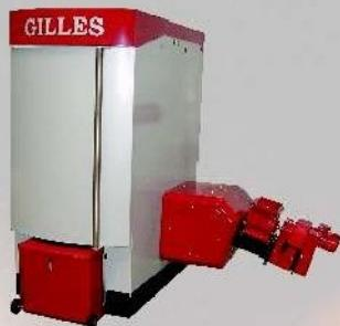
Prevedenie vysoko výkonného vykurovacieho kotla je zo zvarovanej konštrukcie bez prutia. Tepelné izolované predné dverka sa otvárajú smerom dopredu. Plne automatické čistenie kotlových prieduchov pomocou vlastného pohonu a 6 mm závitoviek. Spaľovacia komora na princípe jednosmerného prúdu je vyložená keramickým vymeniteľným obkladom odolným voči vysokým teplotám.
