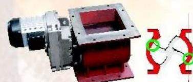
Masívna liatinová konštrukcia s oceľovým turniketovým podávačom. Nosné koleso ohnuté v smere otáčania má vytvrdené a ostro zabrusené kovové lamely. Protostrie je vyhotovené z kalenej nástrojovej ocele. Osvedčené ochranné zariadenie proti spätnému vznieteniu.
